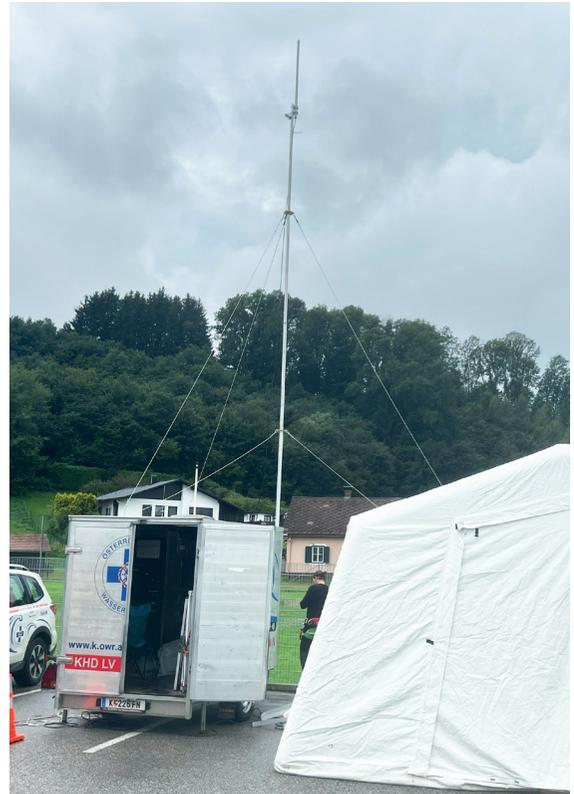
*Einsatzleithänger der ÖWR Kärnten mit aufgebautem Funkmast*
